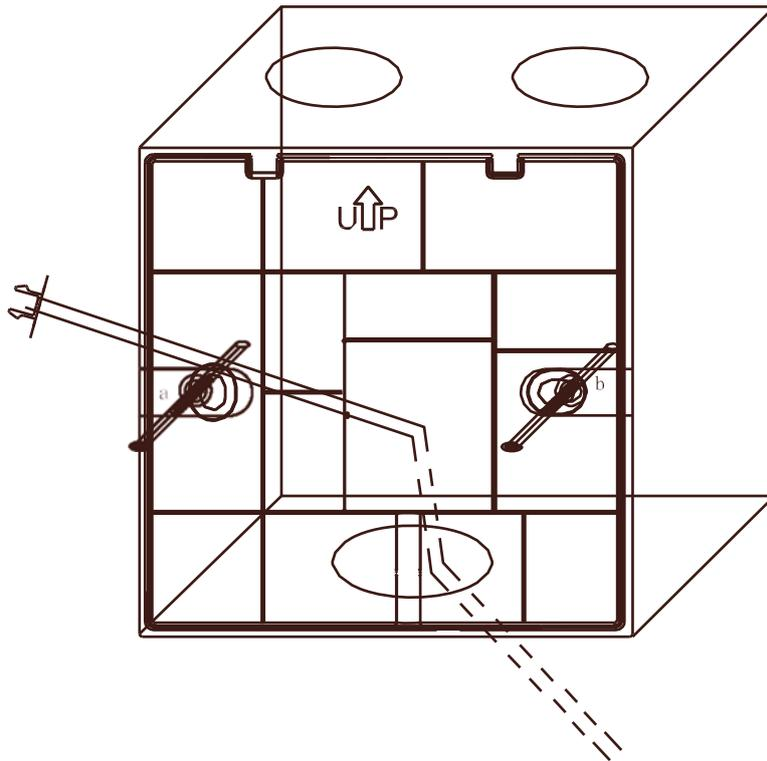
3. Collegare il cavo di comunicazione alla porta posteriore del controller cablato. Il metodo di connessione è il seguente:
