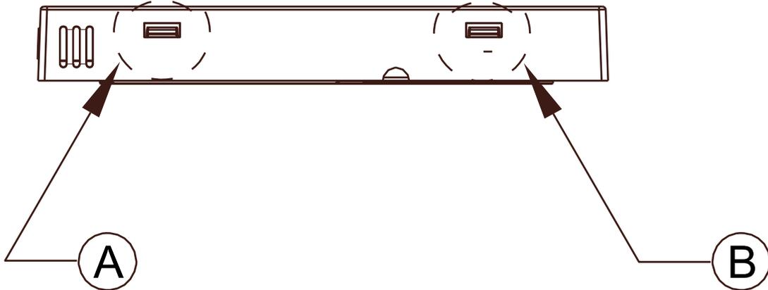
2. Utilizzare le viti per fissare il pannello posteriore del filocomando.
